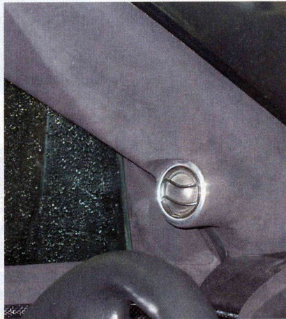
▲ В аудиосистеме применена трехполосная акустика, высокочастотные компоненты которой размещены в стойках
