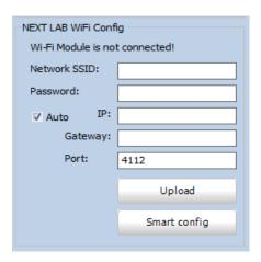
• Введите имя сети (**Network SSID**), пароль доступа (**Password**), если невозможно использование DHCP, введите IP адрес шлюза/клиента (**Gateway, IP**) и снимите чек-бокс Auto. В случаях особой необходимости можно изменить используемый по умолчанию номер порта (**Port**), по которому осуществляется соединение (но это не рекомендуется).
