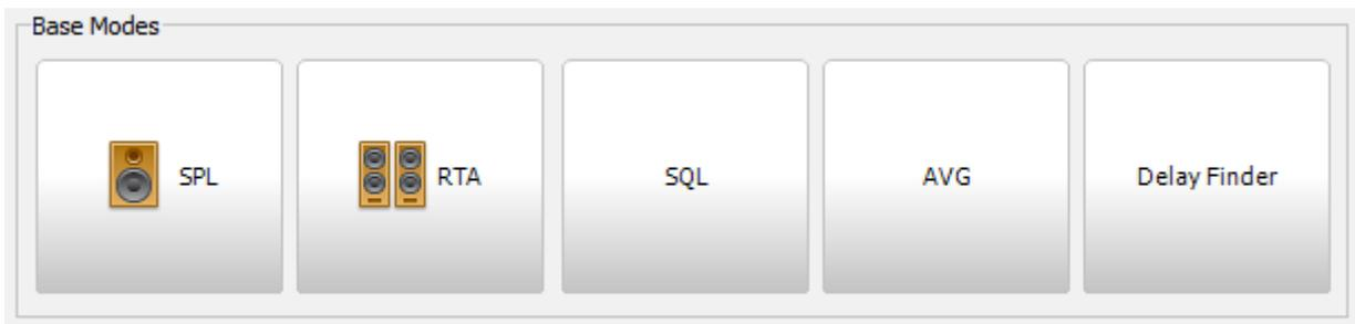
«SPL» – Regime, eingesetzt zur Messung des Spitzenwertes des Schalldruckpegels von Signalen mit einer Frequenz von 10 bis 120Hz mit einer Auflösung 1Hz. Im Regime werden die Form, das Spektrum und der Pegel des gemessenen Signals angezeigt. Der Einsatz von zwei Signalen ist möglich. Dieses Regime unterstützt folgende Vorrichtungen:
