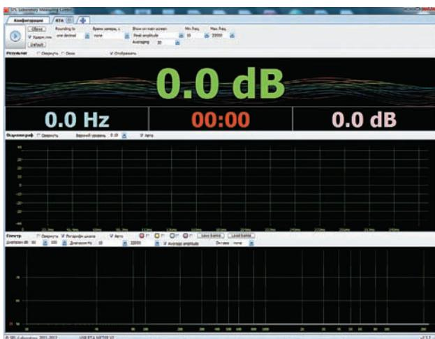
По умолчанию окно разбито на три части: текущий уровень измеряемого звукового давления с запоминанием пикового значения и отображением частоты, на которой показывается максимальный результат; осциллограф и собственно окно, в котором отображается сама АЧХ. И коль мы решили заняться измерением последней, сворачиваем первые два окна и оставляем только RTA.
